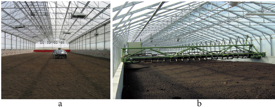
الشكل (2-2-6-2-1-5a,b) أسرة تجفيف الحمأة بالطاقة الشمسية من dyer, suez
