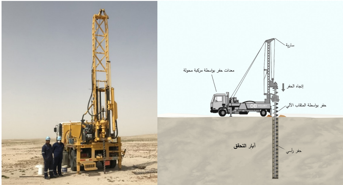
شكل 9: الحفر باستخدام المثقاب الآلي - طريقة القياسات الجيوفيزيائية
