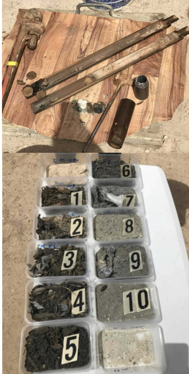
شكل 10: العينات الناتجة عن عملية الحفر بمعدل عينة كل متر واحد - طريقة القياسات الجيو تقنية
